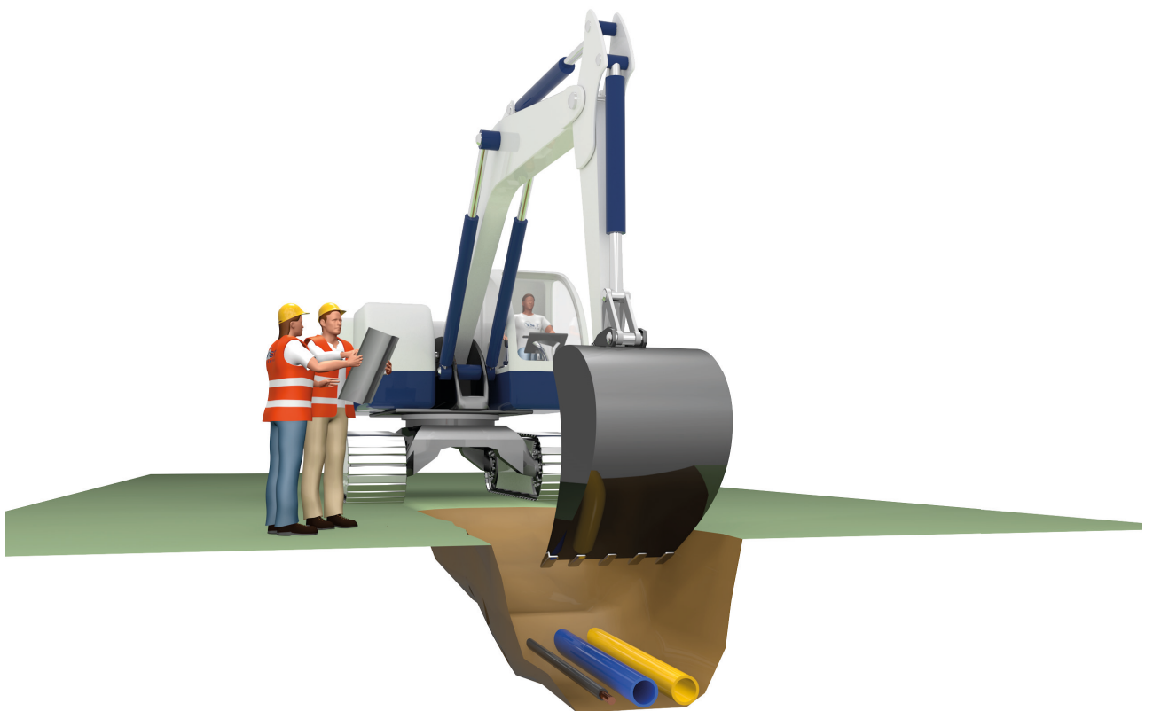
Bild 1 Bagger am Graben mit Versorgungsleitungen, Quelle VST e.V.
